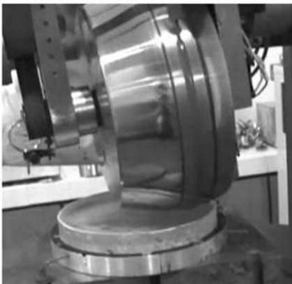
图 6 口径 200 mm 球面镜的磁流变抛光过程 Fig. 6 MRF process of spherical lens(200 mm in diameter)
